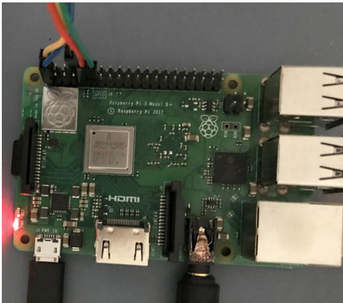
图 3.1 树莓派可经杜邦线连接发射天线等模块
