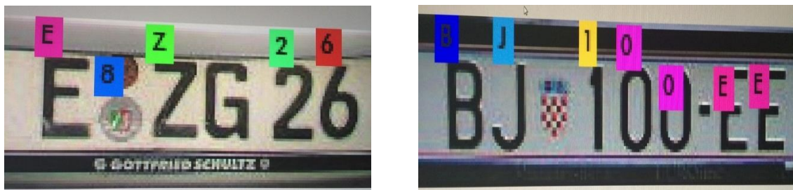
图 2.8 外国车牌字符识别模型结果
