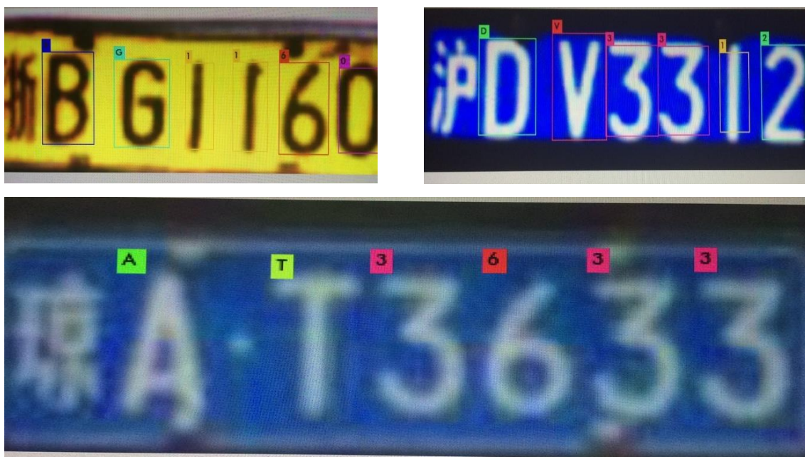
图 2.9 中国车牌字符识别模型结果
